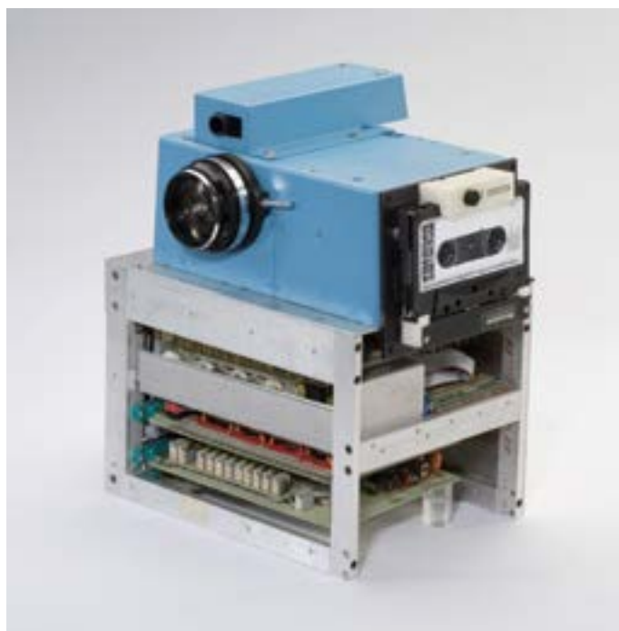
Primera cámara digital. ©Kodak. Utilizada con autorización. Fue inventada para Kodak por Steve Sasson en 1975. Pesaba 3,6 kilos y tenía una resolución de 0,01 megapíxeles.
