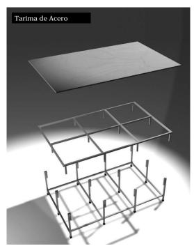
o estructural) de 20 mm. Esto es obligatorio para las estructuras de acero. Para la estructura de madera su uso es optativo, pudiendo ser reemplazada por una cubierta de Masisa de 19 mm., teniendo en cuenta que ésta es muy delicada en los cantos (bordes) y se deteriora con facilidad, lo que puede provocar imperfecciones en el piso y presentar dificultades para los artistas en escena.
